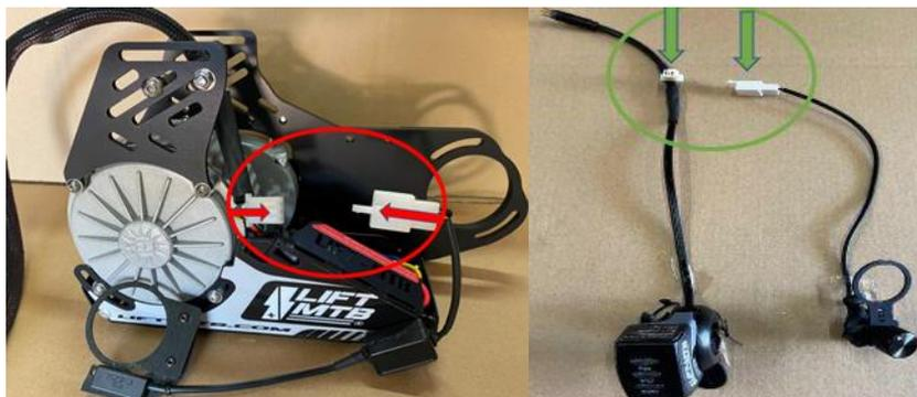
**Para modelos anteriores a agosto de 2020** el funcionamiento sigue siendo el mismo, simplemente el cableado cambia para esto será necesario conectar el conector del sensor en serie en el conector de gatillo (flechas amarillas en la foto).
