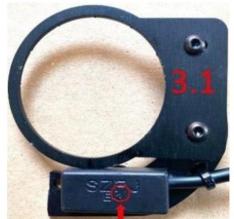
**Attention :** La zone où le capteur détecte le mouvement se situe à la hauteur du "F" de l'écriture "SZFJ" (photo 3.1) cette lettre doit être placée au plus proche de l'axe, toute inversion de position d'un des éléments entraînera un dysfonctionnement.
